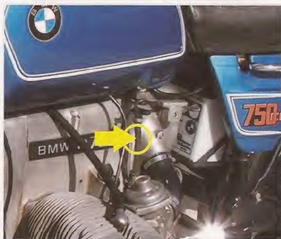
Conductos de gasolina (mangueras)
